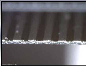
《TCPフィルム 切断面厚 0.12mm》
