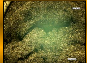
《PC 成形品 ガラス含有率60% 切断面径 φ4mm》
