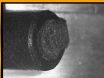
《PC 成形品 ガラス含有率60% 切断面径 φ4mm》
