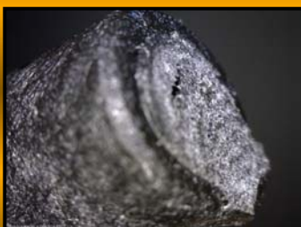
《PC 成形品 ガラス含有率60% 切断面径 φ4mm》
