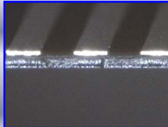
《PC 成形品 ガラス含有率60% 切断面径 φ4mm》
