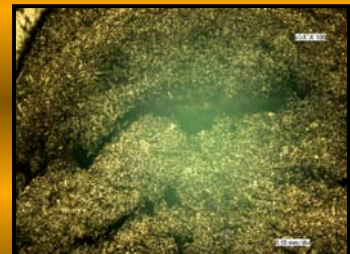
《PC 成形品 ガラス含有率60% 切断面径 φ4mm》
